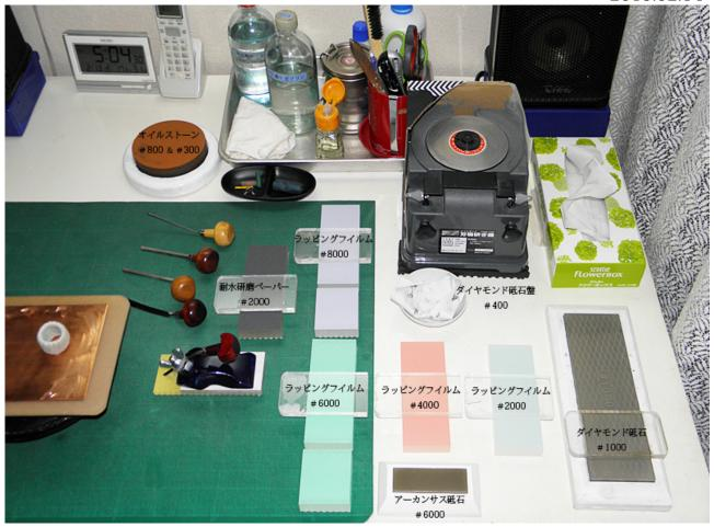
写真はラッピングフイルムをアクリル板に貼りつけたもので、研ぎ器を用いた研ぎに使用する。 使用する粒度は次のようになる。
